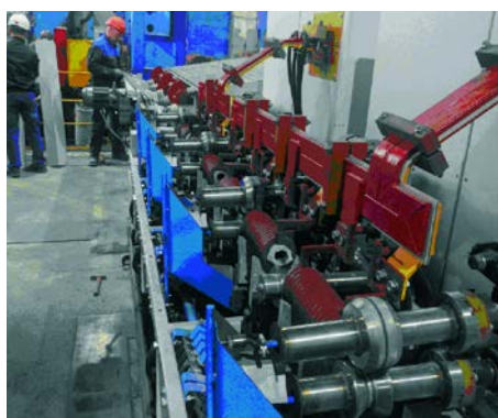
Рис. 3. Загрузочное устройство и нагревательная установка шаропрокатного стана
