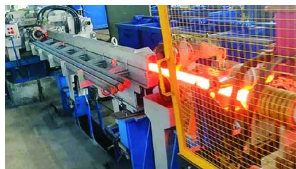
Рис. 4. Поступление нагретой заготовки в желоб загрузки ШПК 20–50
