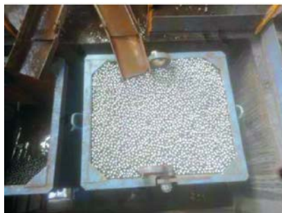
Рис. 1. Мелющие шары Ø16 мм (а) и цилиндрсы Ø22×35 мм (б)
