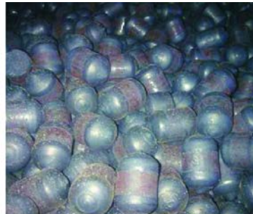
Рис. 1. Мелющие шары Ø16 мм (а) и цилиндрсы Ø22×35 мм (б)
